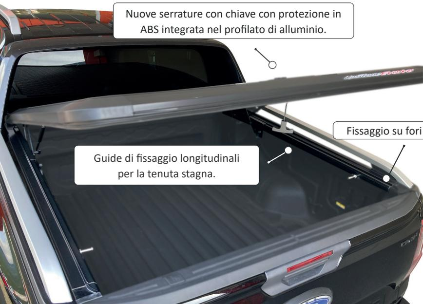
Guide di fissaggio longitudinali per la tenuta stagna.
