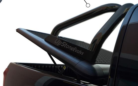
Proposé en accessoire sur les **EVOS450S** et **EVOS451S** ce modèle de roll bar se fixe directement sur le tonneau cover aluminium.
