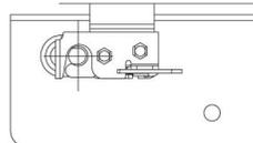
Aligner les gaches (femelle et mâle) de façon à ce que les gaches s'alignent parfaitement.
