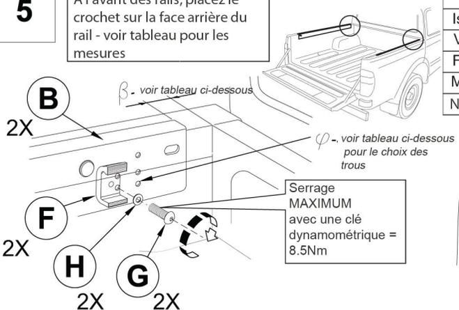
Serrage MAXIMUM avec une clé dynamométrique = 8.5Nm
