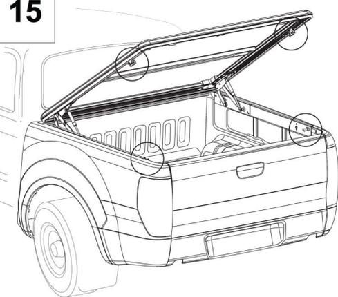
Serrage MAXIMUM avec une clé dynamométrique = 8.5Nm
