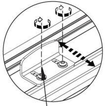
Serrage MAXIMUM avec une clé dynamométrique = 8.5Nm
