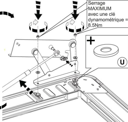
Serrage MAXIMUM avec une clé dynamométrique = 8.5Nm
