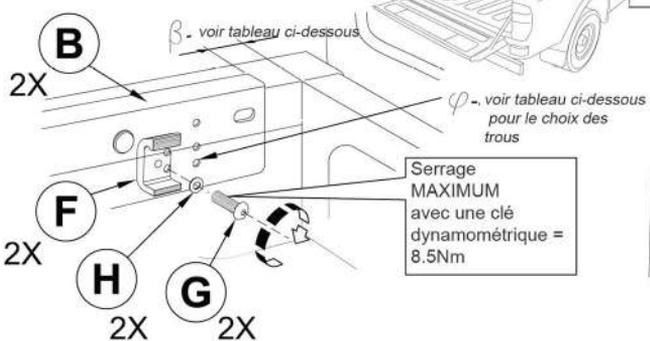
Serrage MAXIMUM avec une clé dynamométrique = 8.5Nm
