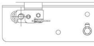
Aligner les gaches (femelle et mâle) de façon à ce que les gaches s'alignent parfaitement.
