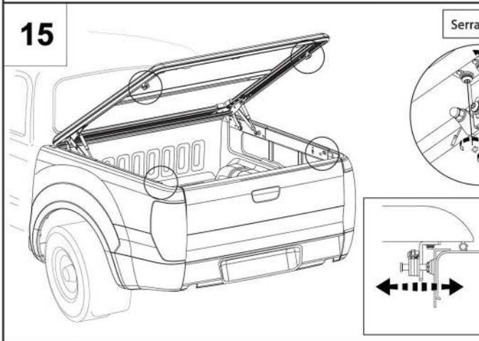
Serrage MAXIMUM avec une clé dynamométrique = 8.5Nm
