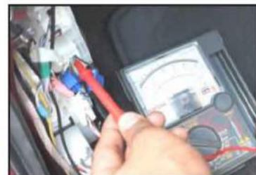
4.2 Appuyer sur les boutons ouvrir et fermer de la clé du véhicule, si le fil est correct l'aiguille du multimètre oscillera vers le haut.
