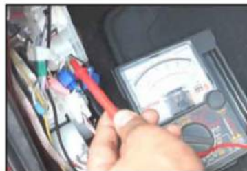
4.2 Appuyer sur les boutons ouvrir et fermer de la clé du véhicule, si le fil est correct l'aiguille du multimètre oscillera vers le haut.
