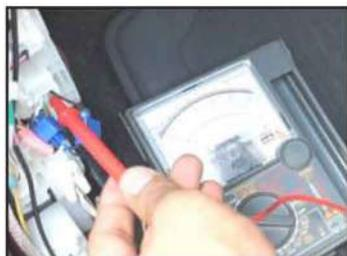
4.1 Pointer le multimètre sur le fil choisi
