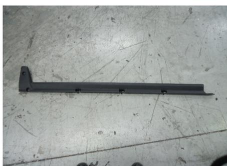
**Étape 2** : Enlever la baguette plastique située en-dessous des rails de part et d'autre de la benne en dévissant **8 vis** (fig.3 & 4), en utilisant un tournevis flexible (fig.5) aux coins les plus éloignés.
