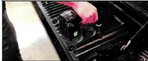
2. Couper le caoutchouc d'étanchéité inférieur à la même largeur que l'intérieur de l'ouverture du hayon de la benne.
