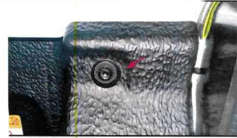
6. Percez les trous le long du bord de la benne, assurez-vous que la plaque est bien jointée. La protection de la porte doit être modifiée afin de permettre au hayon de bien fonctionner selon la largeur désirée.
